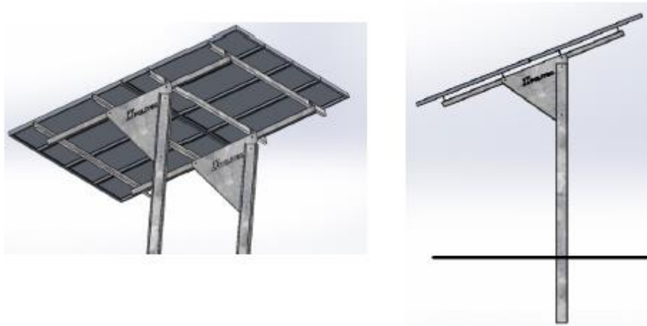
Figura 4.8: Estrutura de fixação para as placas na região, mesa com 8 placas
